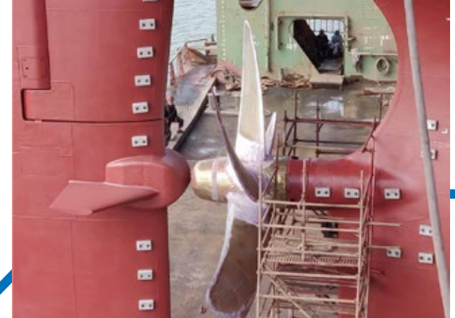
Rudder Bulb Fin on M/V TROODOS SUN
